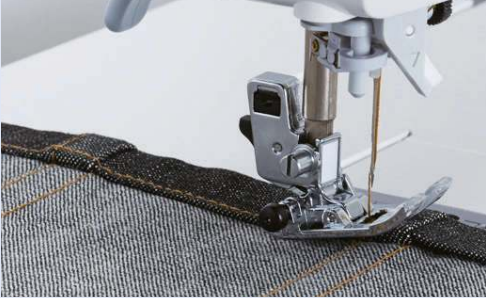
Müheles gleichmäßiges Nähen von dicken Stoffen. Auch das Säumen von Jeans im Bereich der Kapp- bzw. Quernähte können problemlos verarbeitet werden.
