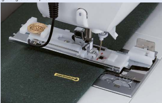
Der Knopflochfuß enthält zusätzlich noch ein Klemmschiene. Das Material wird zwischen dem Nähfuß und der Schiene gehalten, so dass ein exakter Stofftransport gewährleistet ist.
