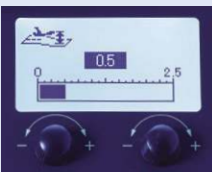
Die Nähfußhöhe kann in 0,1 mm Schritten angepasst werden und ermöglicht eine exakte Abstimmung bei schwierigen Materialien.
