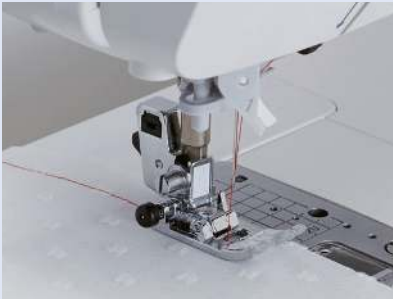
Nähen von dünnen Stoffen. Auch beim Nähbeginn sorgt der Transporteur für eine von Anfang an perfekte Naht.
