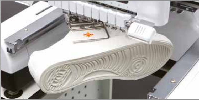
Klemm Rahmen R+L zum Einspannen großer Schuhe.
