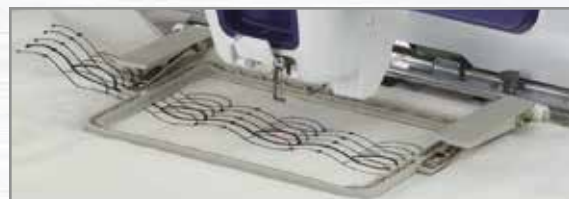
Die PR bietet einen Stickbereich von 300 x 100 mm. Die VR bietet einen Stickbereich von 180 x 100 mm.
