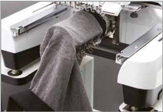
Einfaches Einspannen von Hemdärmeln, Hosenbeinen, Taschen und Ähnlichem.
