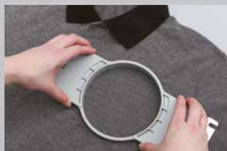
Das Fixieren des Kleidungsstücks ist in jede Richtung möglich. Die Mitte des Rahmens muss sich dabei an der gewünschten Stelle befinden.
