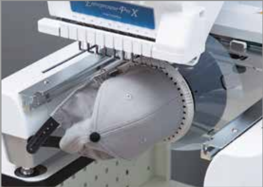
Dicht am Kappenschirm stecken
