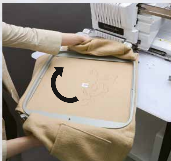
Rahmen drehen und fertig sticken ohne umzuspannen
