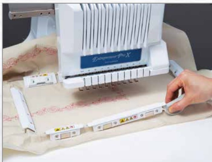
Inklusive Magnetheber zum einfachen Lösen der Magnete
