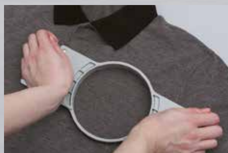
Das Fixieren des Kleidungsstücks ist in jede Richtung möglich. Die Mitte des Rahmens muss sich dabei an der gewünschten Stelle befinden.
