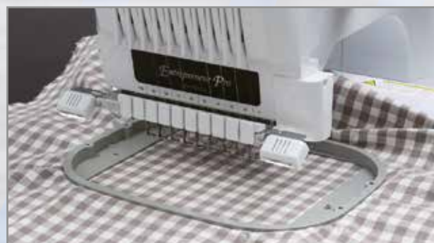
Der quadratische Rahmen vereinfacht das Ausrichten von Quilt-Mustern.
