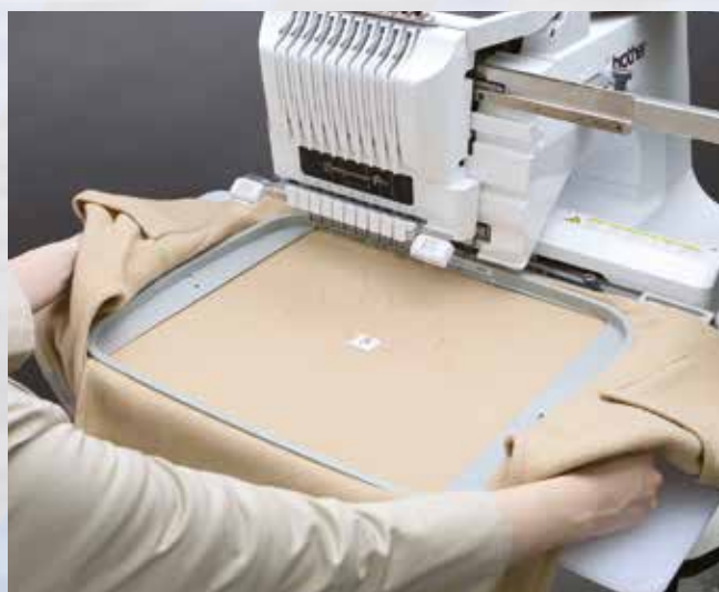
Stoff einspannen und die erste Hälfte des Musters sticken.
