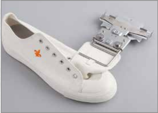
Speziell entwickelt zum Besticken von Schuhzungen.
