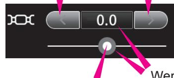
Die Fadenspannung kann auch durch Verschieben des Reglers eingestellt werden.
