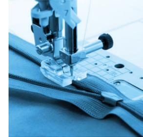
**Nähfuß für nahtverdeckten Reißverschluss.**
